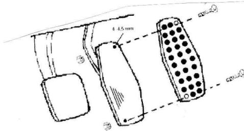
クラッチとブレーキペダルプレートを次のように取り付けます。
